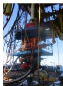
ภาพถ่ายที่ 2.2-19 อุปกรณ์ป้องกันการพลุ่ง (Blowout Preventer : BOP)
